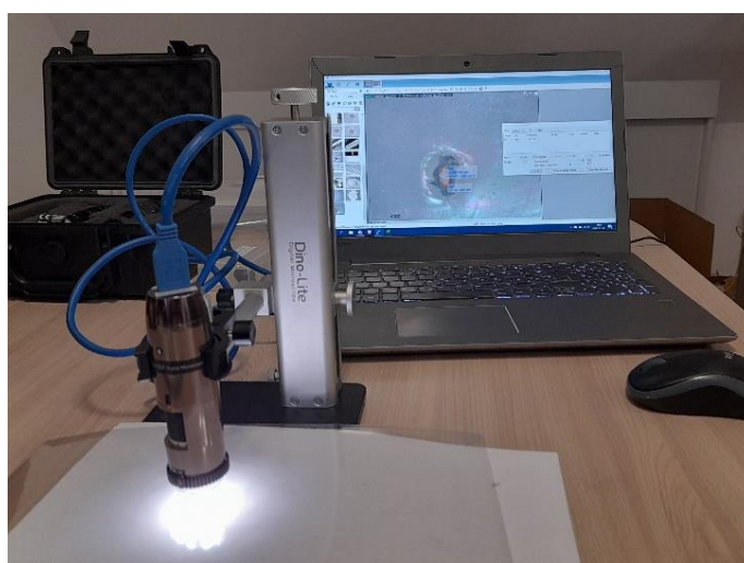
26. ábra: Mikroperforációk vizsgálata digitális mikroszkóppal
